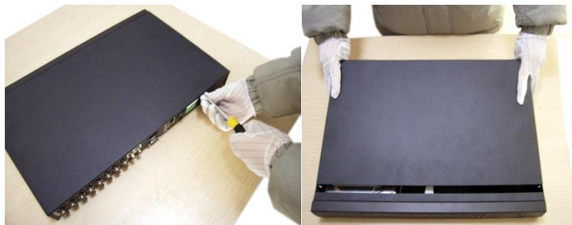
Открутите шурупы и снимите верхнюю крышку устройства
