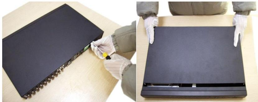
Открутите шурупы и снимите верхнюю крышку устройства
