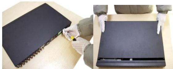
Открутите шурупы и снимите верхнюю крышку устройства
